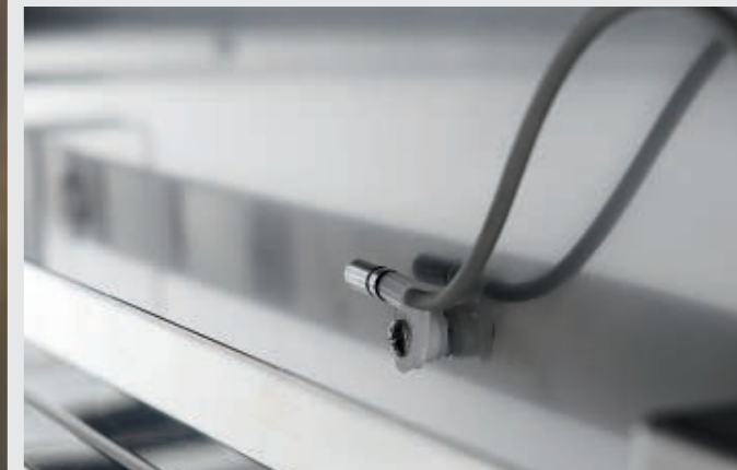
Sonda interno cella per il controllo costante della temperatura. Sonde interne pour un contrôle constant de la température. Sonda dentro de la celda para el control constante de la temperatura.
