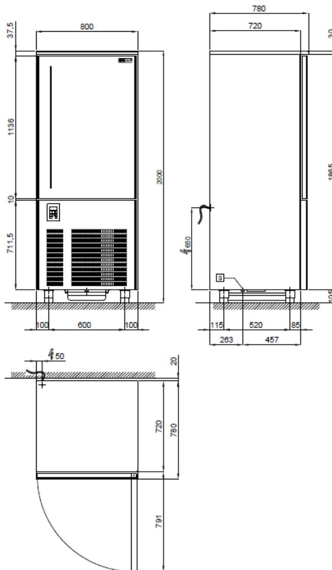
Alimentazione elettrica: 3x1.5 mm<sup>2</sup> cavo con spina Shchuko; L=4000 mm
